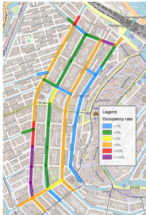
Figuur 5.6: De gemiddelde bezettingsgraad van de rakkens gedurende 10 uur met de nulmeting.
